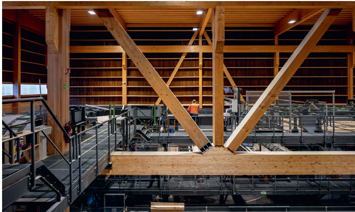
Das Schnittholz wird auf drei Arbeitsebenen für den Trocknungsprozess vorbereitet. Auf den erhöhten Laufstegen haben die Mitarbeitenden die Förder-, Sortier- und Paketieranlagen im Blick.
